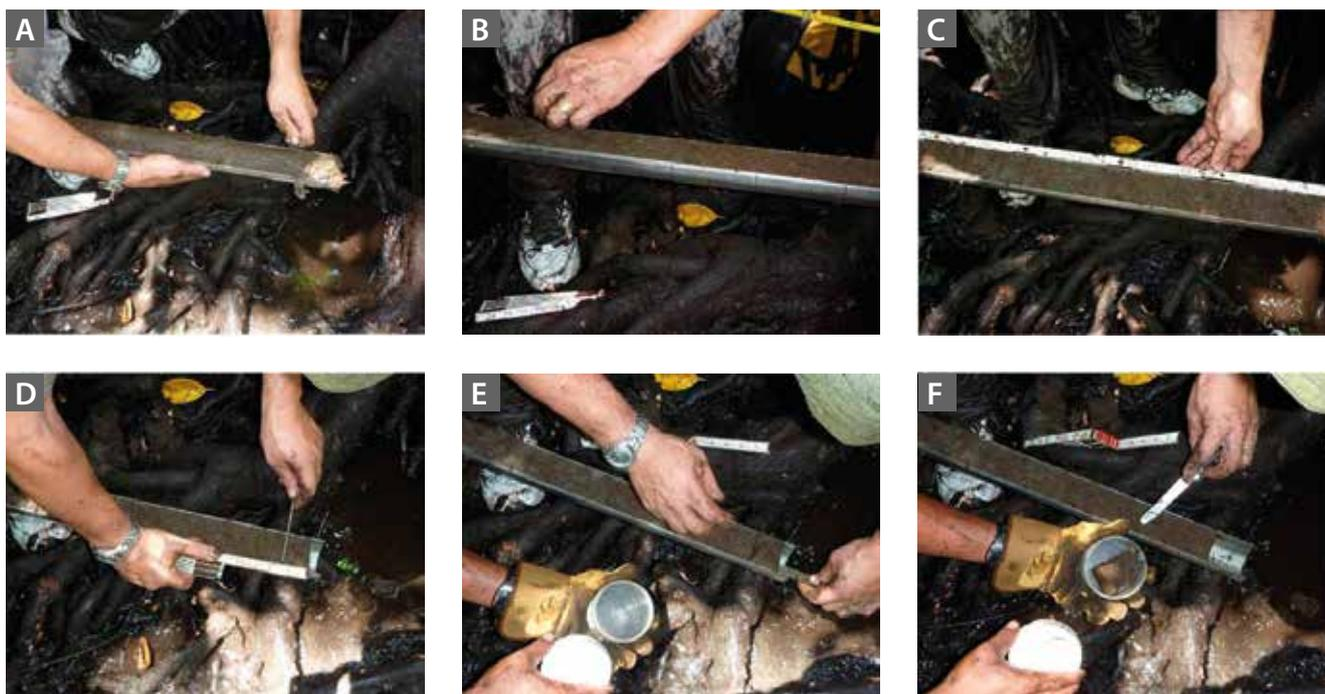
**Figura 20. Colecta paso a paso de muestras de sedimento utilizando un nucleador**
